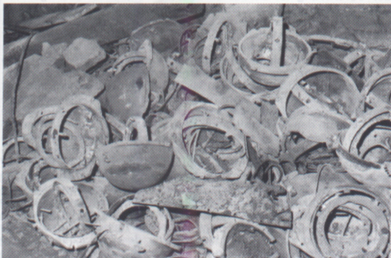
Links: Ein Haufen kugelförmiger Behälter für den gyromagnetischen Kompass der V1. Rechts: Ein V1-Treibstofftank.
