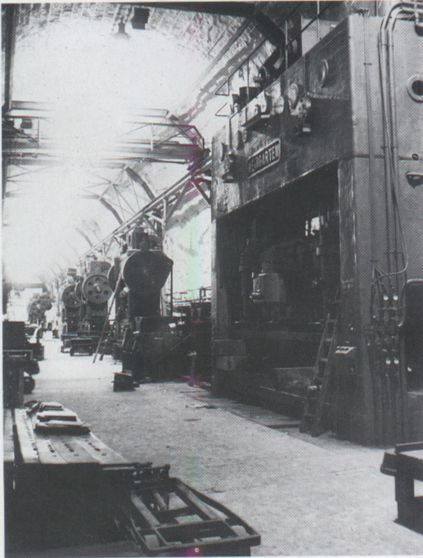
Rechts: Im Querstollen 32 und 33 befand sich die Presserei. Die mächtige Weingarten-Pressen im Vordergrund war 6,5 m hoch. Beide Querstollen sind heute überflutet, aber Taucher haben kürzlich die Fundamente der Pressen identifiziert. (BA) Links: Die Heckteile der V2 wurden im Quer-
